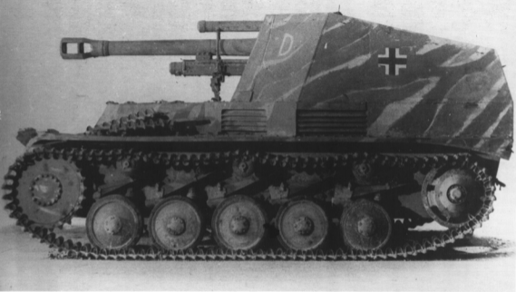
Der Zusammenbau der leichten Feldhaubitze 18/2 mit dem Fahrgestell des Kampfpanzers II ergab die "Wespe"
