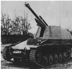
Das Höhenrichtfeld der "Wespe" betrug 42°, das Seitenrichtfeld 40. Die Feuerhöhe war 1,94 m.
