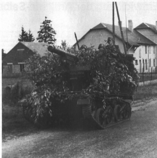
Als erstes Beispiel der vielen Improvisationen auf Beutefahrzeugen – weitere am Ende dieses Bandes – hier der Zusammenbau einer 10,5-cm-IFH 16 auf dem Fahrgestell des englischen Kampfpanzers Mk IV 736. Von ihm gab es nur sehr wenige.
