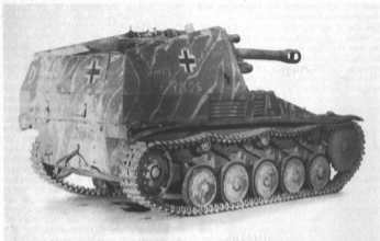
Ursprünglich nur als eine Zwischenlösung geplant, blieb, da es zu keiner Endlösung kam, die "Wespe" die meistgebaute deutsche leichte Feldhaubitze auf Selbstfahrlafette.
